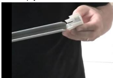
4. Na horný vodiaci profil nasunte horné rohové spájače
